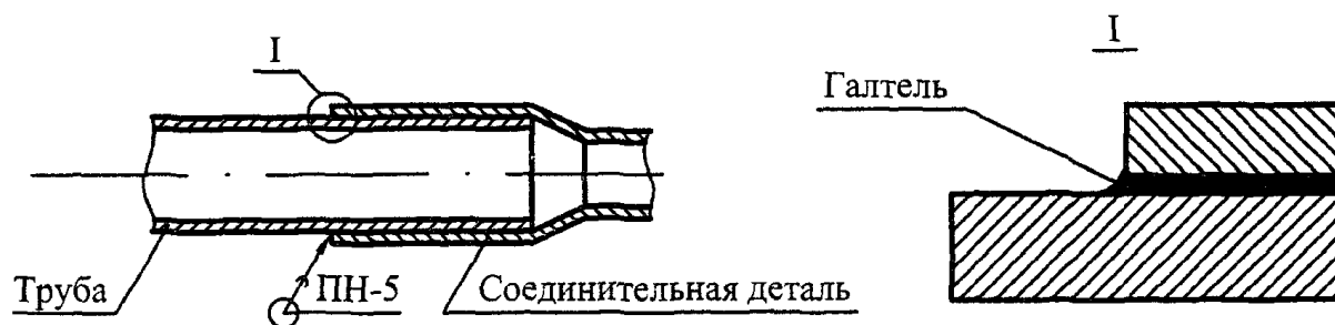
Рисунок 16. Схема паяного соединения
